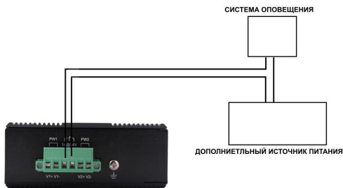
Рис.8 Схема подключения системы оповещения к коммутатору SW-8042/IF
