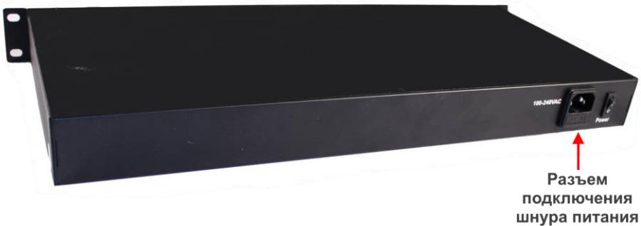
Рис. 3 Коммутатор SW-21600/HB, вид сзади
