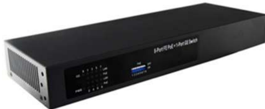
Рис.2 Коммутатор SW-20810/C , внешний вид
