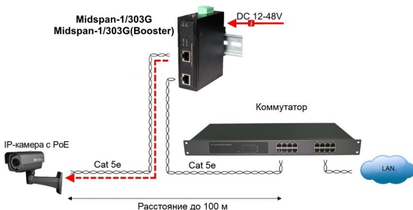
Рис.4 Типовая схема подключения инжекторов Midspan-1/303G, Midspan-1/303G(Booster)
